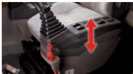
Control de movimientos (joystick) ajustable en altura
